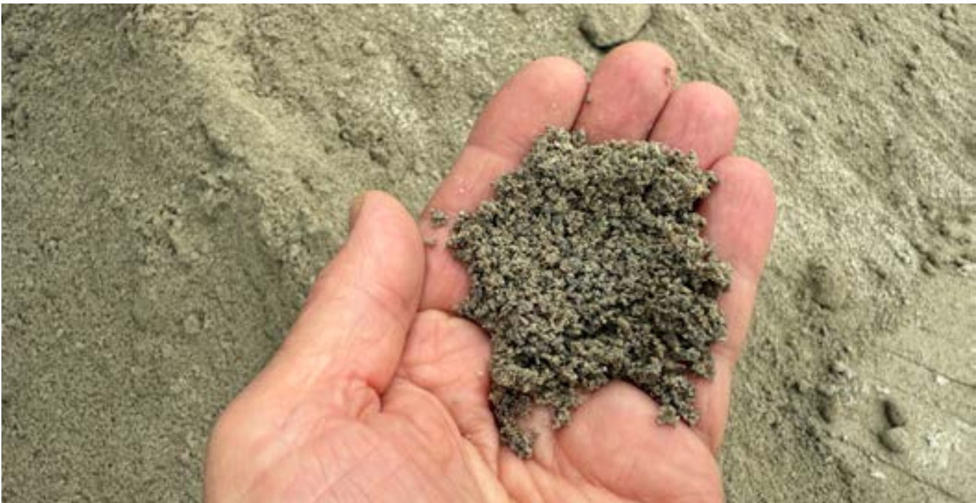
Typisk sandjord (2-0,06 mm). En jordart som oftast är både stabil för belastning och vattengenomsläpplig som ofta innebär lite vatten i underlaget. Foto: Magnus Hellqvist
